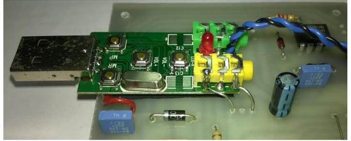
Interfaccia audio USB liberata dal suo contenitore e pronta per il fissaggio sul circuito stampato. Nella vista da sotto si può notare il filo rosso che andrà ad alimentare l'interfaccia (collegato ai +5V della USB). La massa viene collegata direttamente alla schermatura della presa USB, tramite due reofori da saldare in corrispondenza delle linguette che la fissano al circuito stampato.
